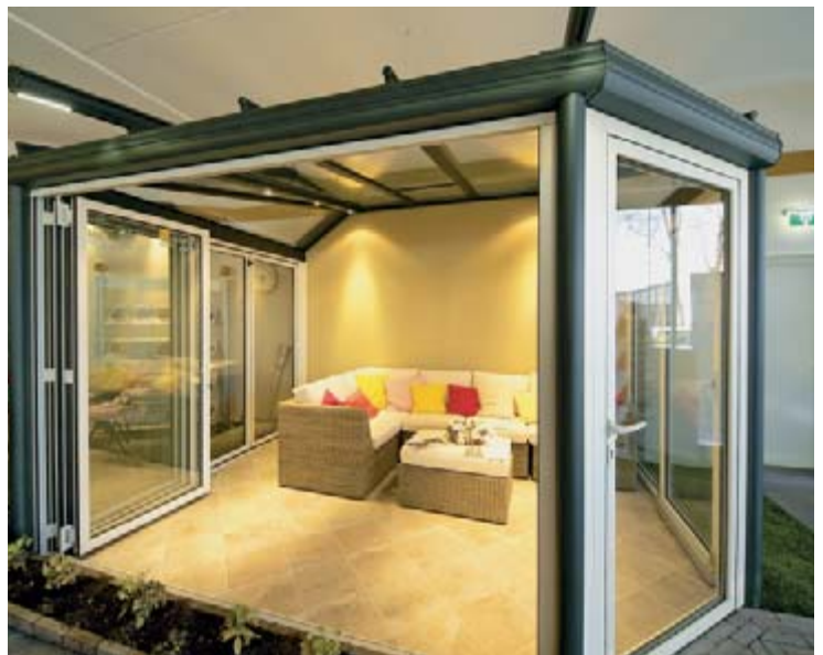
▲ Die Unterbauelemente schließen immer innen an Pfosten oder Dachträger an.
